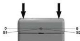
L'interruttore basculante dispone di 2 punti di commutazione controllabili uno indipendentemente dall'altro. Ad ogni punto di commutazione è assegnata una funzione di controllo di un componente protesico.
