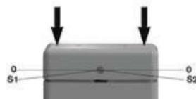
El interruptor basculante dispone de 2 puntos de conmutación que se activan independientemente el uno del otro. A cada punto de conmutación le corresponde una función de los componentes protésicos que han de manejarse.
